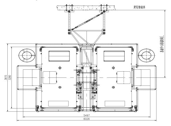
其中图中尺寸 L 根据工地实际情况选用附墙的类型而定.
